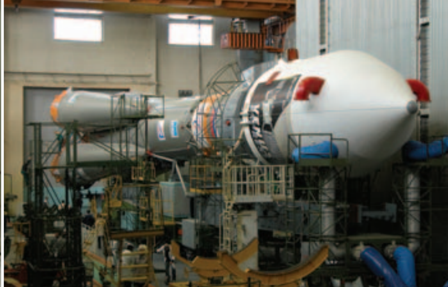
Montage de Venus Express avec l'étage de fusée Frégate sur le cosmodrome de Baïkonour au Kazakhstan, environ un mois avant le lancement.
