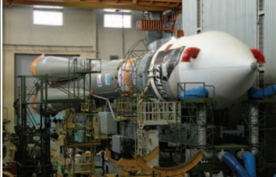
De Sojuez-Fregatlanceerraket van Venus Express wordt in de MIK 40-montagehal op Bajkonoer klaargemaakt voor de lancering. © ESA
