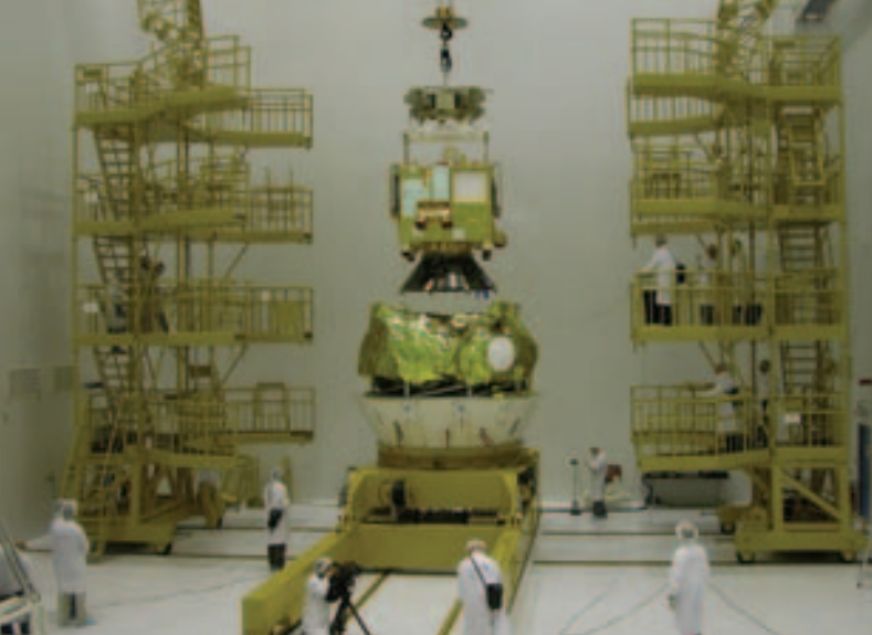
Montage van Venus Express met de Fregat-raket-trap op de kosmodroom Bajkonoer in Kazachstan, ongeveer een maand voor de lancering. © ESA
