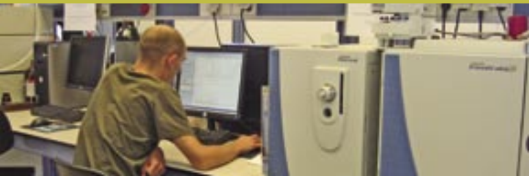
Gaschromatograaf gekoppeld aan een massaspectrometer. (©KIK-IRPA)
