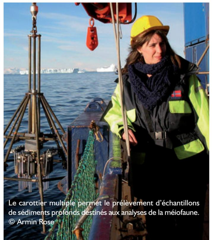
Le carottier multiple permet le prélèvement d'échantillons de sédiments profonds destinés aux analyses de la méiofaune. © Armin Rose
