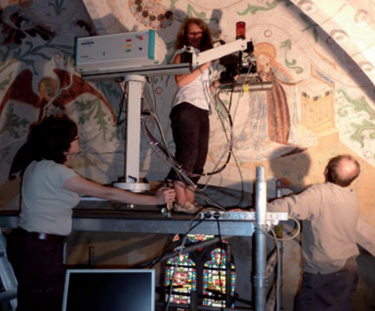
9. Examen *in situ* : l'appareil XRF est installé sur un échafaudage et monté sur un socle stable. Son bras articulé permet d'approcher la surface peinte. Chaque mesure dure 2 minutes et livre immédiatement les résultats qui s'affichent sur un écran d'ordinateur. Les scientifiques et restaurateurs interprètent ces résultats et décident des prochains endroits à mesurer. © M. Van Bos.
