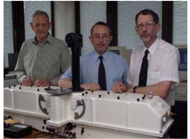
Le trou d'ozone en Antarctique a été découvert en 1985, par trois scientifiques de la British Antarctic Survey, de gauche à droite : Joe Farman, Brian Gardiner et Jon Shanklin, derrière un spectromètre Dobson utilisé pour mesurer les concentrations de l'ozone stratosphérique. © British Antarctic Survey
