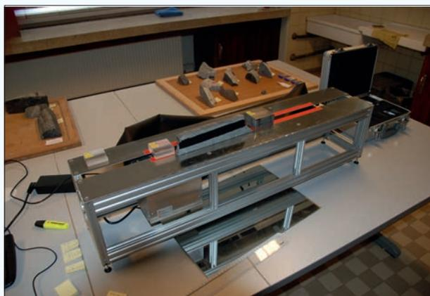
Le Thermal Conductivity Scanner dans l'un des laboratoires du Service géologique (© IRSNB, Estelle Petitclerc)
