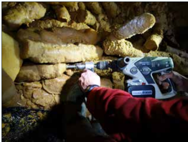
Figure 5 : Échantillonnage de mini-carottes pour datation des structures. ©SSAC
