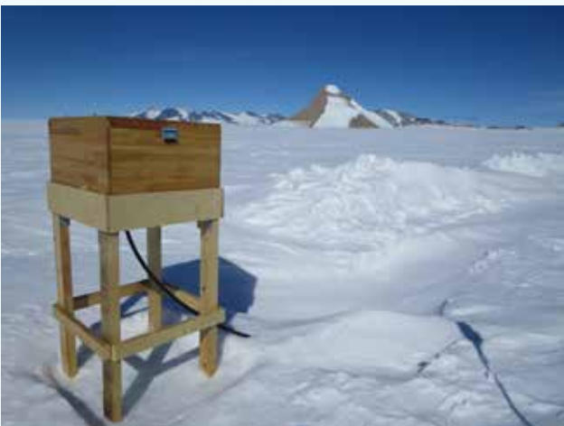
Figure 4 : Instrument fixé sur la table en bois, elle-même enfoncée dans 1 mètre de neige et de glace. Au loin à droite, on distingue les éoliennes de la station Princesse Elisabeth. © Darrouzet
