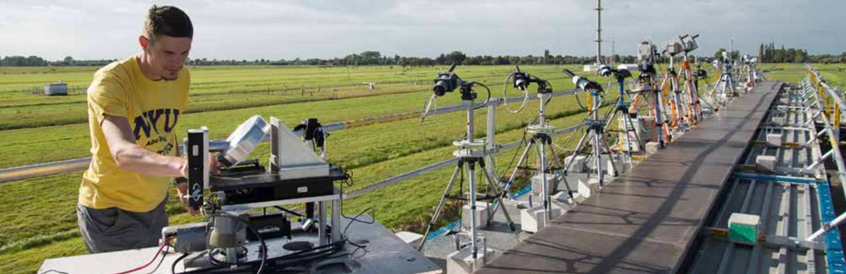
Figure 1: Les instruments MAX-DOAS installés sur le toit des containers.
