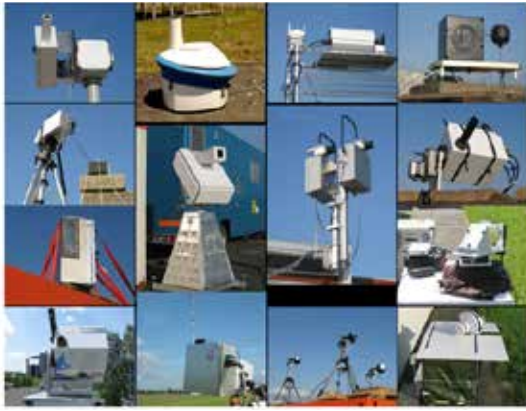
Figure 2: Mosaique illustrant les différents types d'instruments MAX-DOAS utilisés pendant CINDI (© A. Piters, KNMI).
