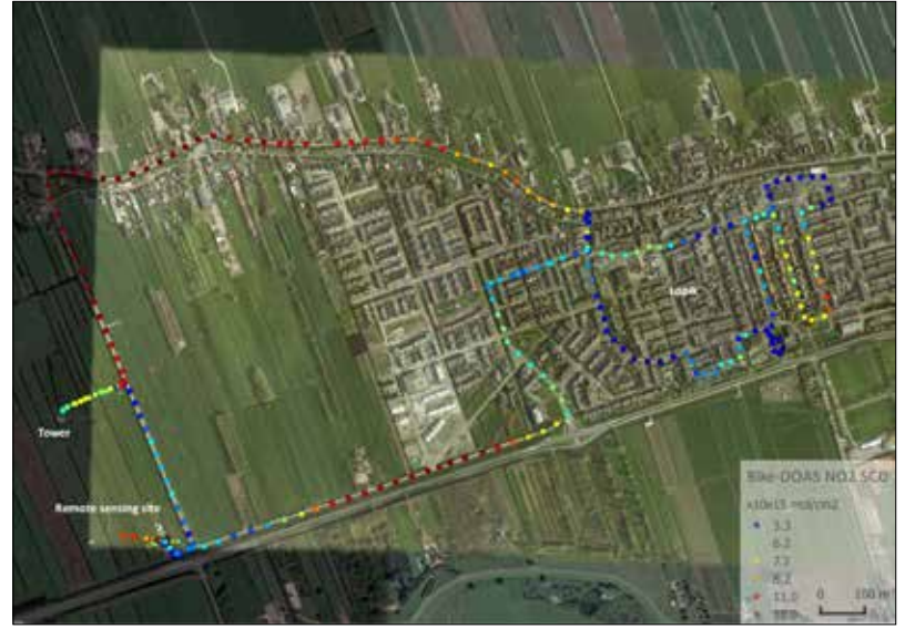
Figure 8: Carte de distribution du \text{NO}_2 basée sur les mesures d'un instrument DOAS compact monté sur un vélo.
