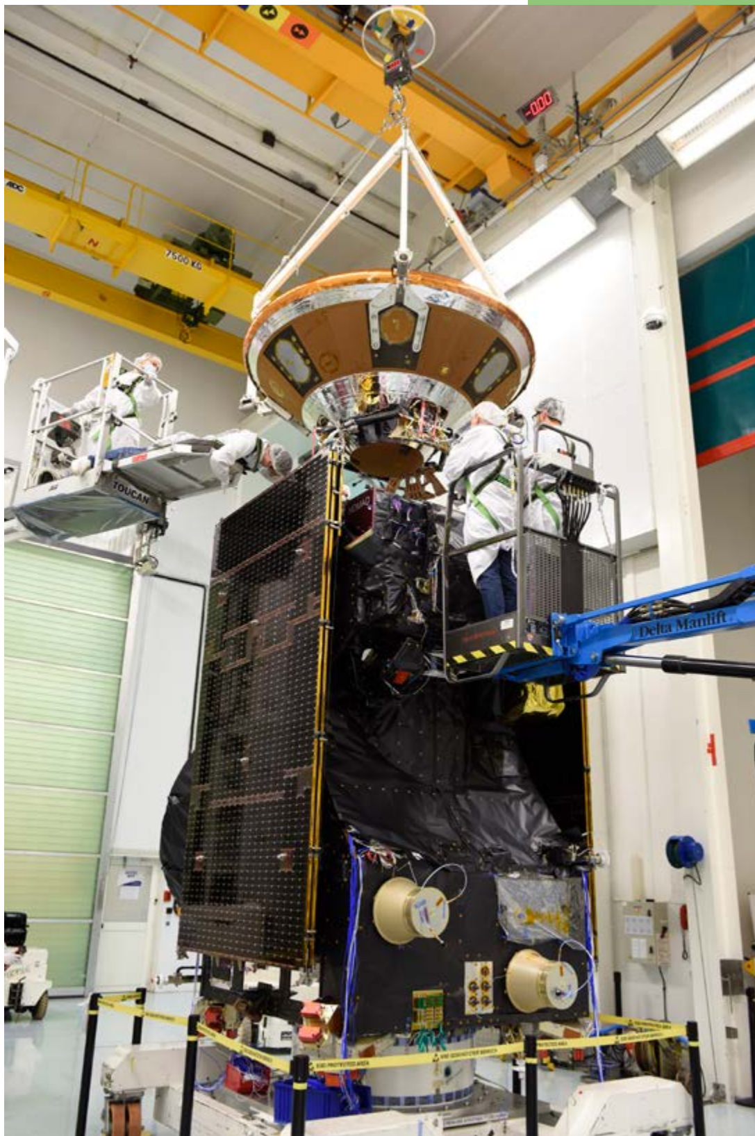
Het wetenschappelijk instrument NOMAD, ontworpen en vervaardigd door het Koninklijk Belgisch Instituut voor Ruimte-Aeronomie, tijdens de integratie in de Trace Gas Orbiter-satelliet. Deze satelliet is het eerste onderdeel van de ExoMars-missie, een gezamenlijke missie van de Europese (ESA) en Russische (Roscosmos) ruimtevaartorganisaties. NOMAD bevindt zich momenteel in een baan rond de planeet Mars.
