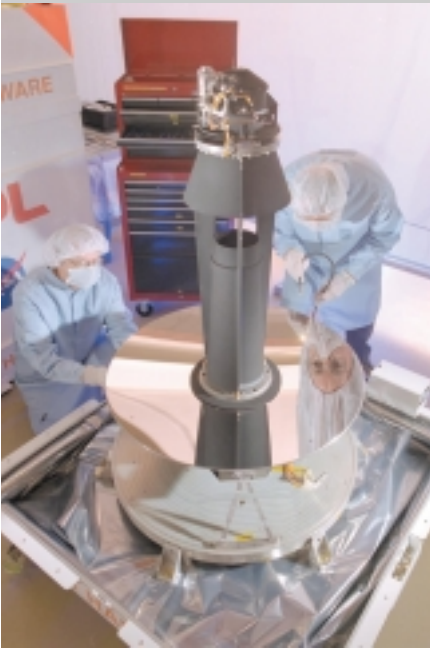
↙ De spiegel voor de infraroodtelescoop SIRTIF. (document NASA-JPL)
