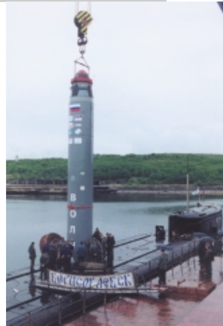
↑ Cosmos wordt gelanceerd vanaf een onderzeeboot met een Russische ex-ballistische raket, omgebouwd tot lanceerraket. (The Planetary Society).
